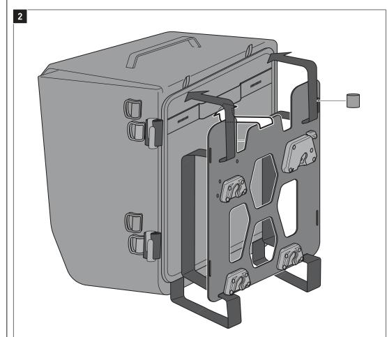
Verschlaufen Sie die Adapterplatte zunächst locker mit den vertikalen Gurten an der SysBag. Schieben Sie dabei die mittlere Nase der Adapterplatte unter die gezeigte Lasche am Taschenrücken.
