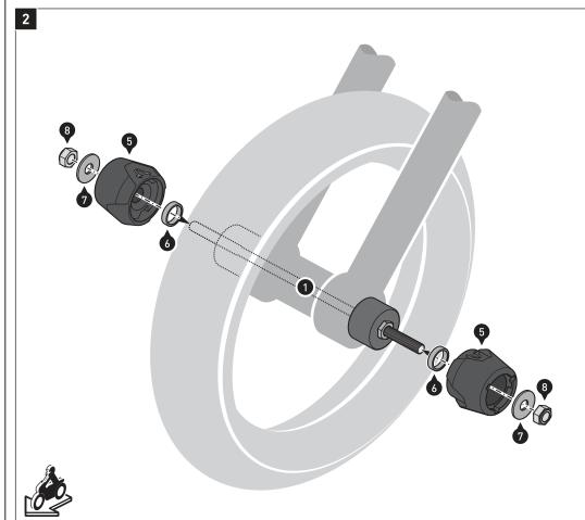
Montieren Sie die Sturzpads (5) mit den Muttern (8) **beidseitig** an der Gewindestange (1). Ziehen Sie die Muttern (8) wie vorgegeben an.
