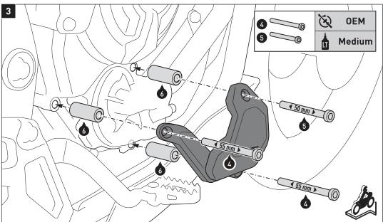
Verschrauben Sie den Wasserpum-penschutz am Fahrzeug, wie in der
