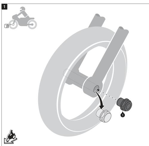
Entfernen Sie auf der linken Fahrzeugseite die original Achsschraube.
