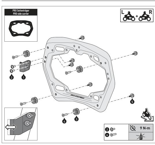
HINWEIS: Die Zeichnung zeigt die Montage am **rechten** PRO-Seitenträger. Montieren Sie die Teile am linken PRO-Seitenträger auf die gleiche Weise wie am rechten PRO-Seitenträger.
