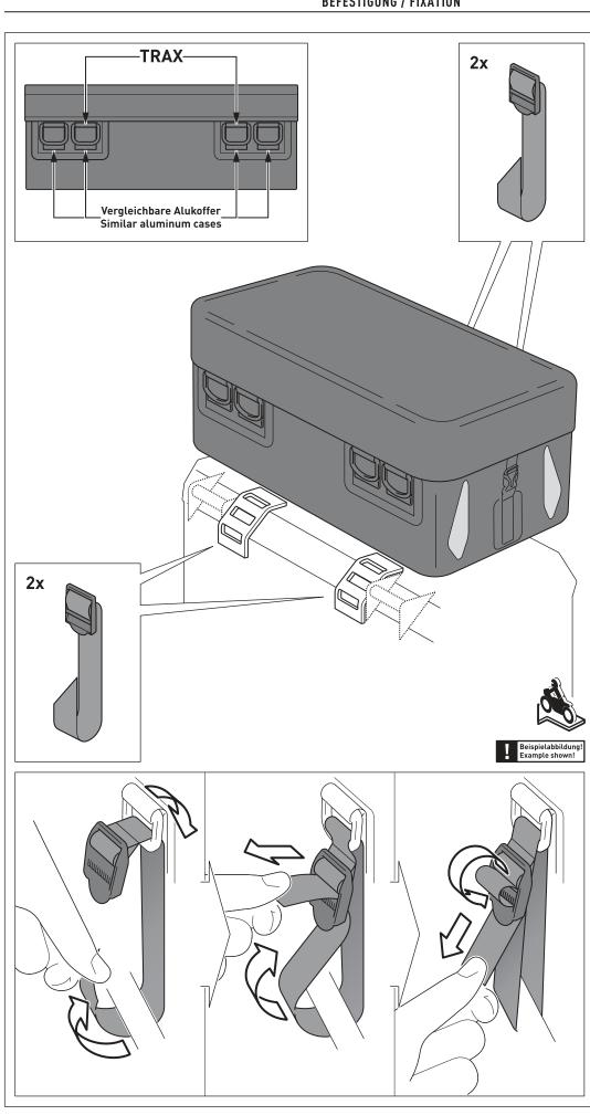
Platzieren Sie die TRAX Zusatztasche auf dem Deckel des TRAX Alukoffers oder einem vergleichbaren Alukoffer.
