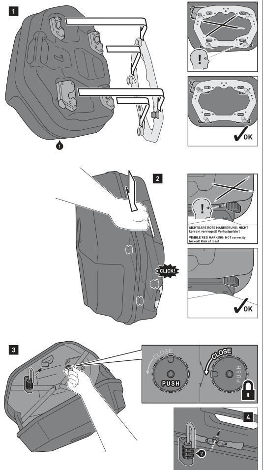
Schritt [1]: Setzen Sie die vier Arretierungsöffnungen des Seitenkoffers (1) auf die Führungsbolzen des montierten SW-MOTECH Seitenträgers.
