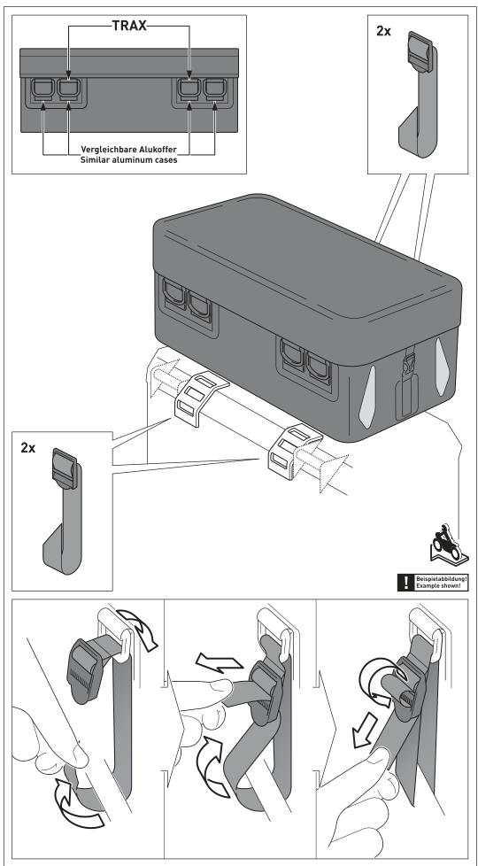
Platzieren Sie die TRAX Zusatztasche auf dem Deckel des TRAX Alukoffers oder einem vergleichbaren Alukoffer.
