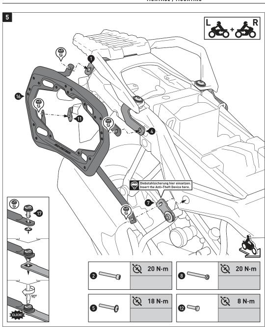
Verbinden Sie die Kofferträger (16) mit den Schnellverschlüssen (17) an den Querverbindern (1) und (11) und den Befestigungslaschen (4) und (7), wie in der Zeichnung gezeigt. Sichern Sie die Schnellverschlüsse (17) mit den Sicherungsscheiben.
