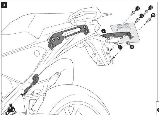
Verschrauben Sie den Querverbinder (9) am Nummernschildhalter. ACHTUNG: Verwenden Sie flüssige
