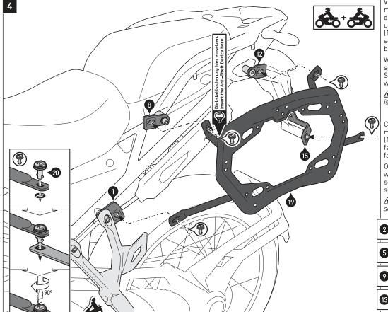
Verbinden Sie die Seitenträger [19] mit den Schnellverschlüssen [20] an den Befestigungslaschen [1], [4], [8] und [12] und dem Querverbinder [15]. Sichern Sie die Schnellverschlüsse mit den Sicherungsschei-
