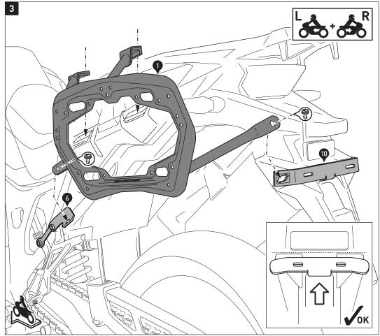
Hängen Sie die Seitenträger beidseitig in die Heckmulden des Fahrzeugs und verbinden Sie diese mit den Schnellverschlüssen (15) am Querverbinder (10) und den Befestigungslaschen (6).
