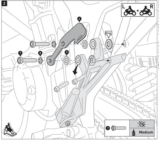
Entfernen Sie die original Schrauben von den Soziusfußrasten. Verschrauben Sie nun die Befestigungslaschen (6) mit den original Unterlegscheiben (Orig.) an den Soziusfußrasten, wie in der Zeichnung gezeigt.
