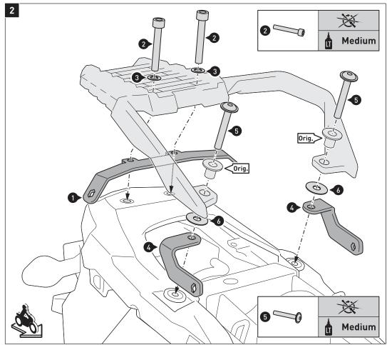
Verschrauben Sie den Querverbinder (1) und die Befestigungslaschen (4) mit den original Bundbuchsen (0rig.) und Gepäckträger am Fahrzeug, wie in der Zeichnung gezeigt
