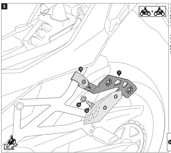
Verschrauben Sie die Befestigungslaschen (7) auf beiden Seiten des Fahrzeugs an den Schellen (10).
