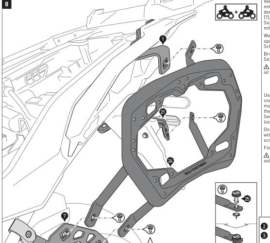
Verbinden Sie die Seitenträger (24) mit den Schnellverschlüssen (25) an den Befestigungslaschen (1) und (7), sowie am Querverbinder (21). Sichern Sie die Schnellverschlüsse mit den Sicherungsscheiben.
