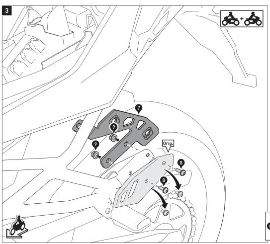
Entfernen Sie beidseitig die Fersenschützer und verschrauben Sie diese mit den Befestigungslaschen (7) wieder an den Fußrastenhaltern. Ziehen Sie die Schrauben noch nicht
