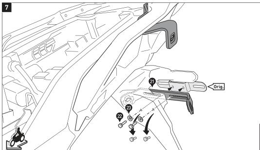
Entfernen Sie den Nummernschildhalter (Orig.) und verschrauben Sie ihn zusammen mit dem Querverbinder (21) wieder am Fahrzeug.
