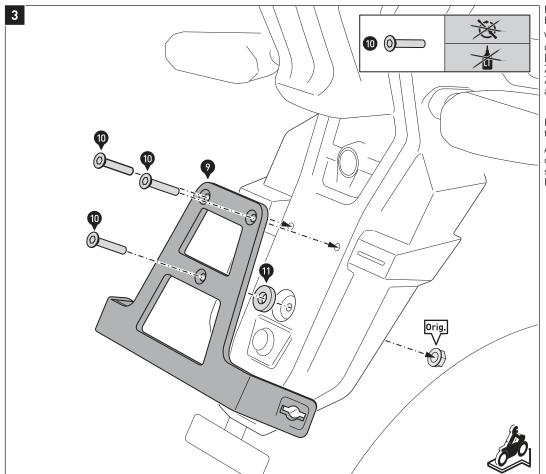
Entfernen Sie die original Schrauben vom Kennzeichenhalter.
