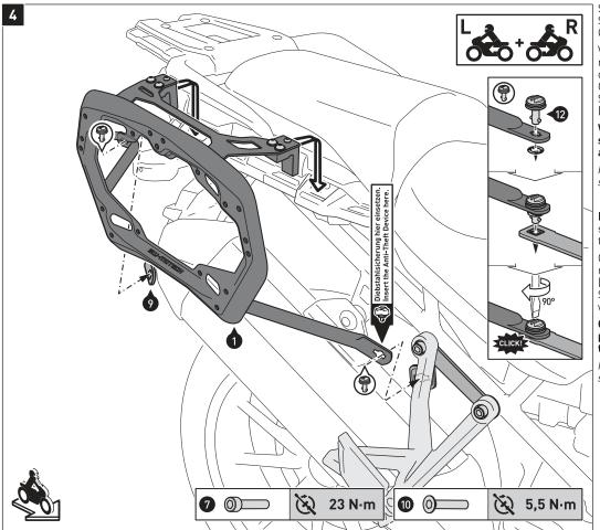
Setzen Sie die Einschubnasen der Seitenträger (1) beidseitig in die Öffnungen der Heckverkleidung ein.
