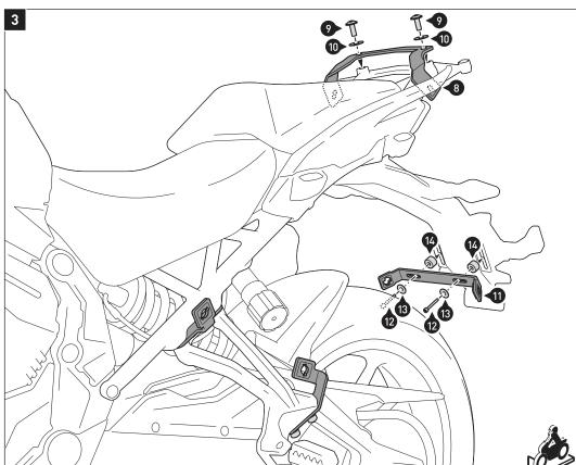
HINWEIS: Wenn der Seitenträger mit dem SW-MOTECH Gepäckträger montiert wird, entfallen die Teile (9) & (10). Verwenden Sie stattdessen die Teile des Gepäckträgers.
