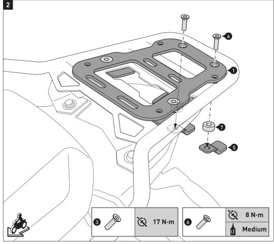
Montieren Sie die Schellen (5) mit dem Anbaublech (1), wie in der Zeichnung gezeigt. ACHTUNG: Verwenden Sie flüssige
