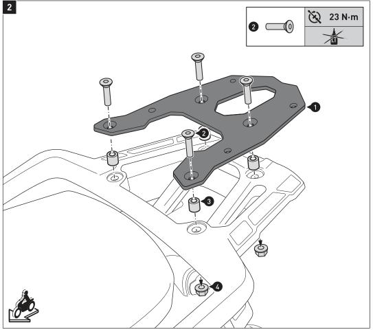
Montieren Sie das Anbaublech [1] am Gepäckträger, wie in der Zeichnung gezeigt. Ziehen Sie die Schrauben wie in der Stückliste vorgegeben an.
