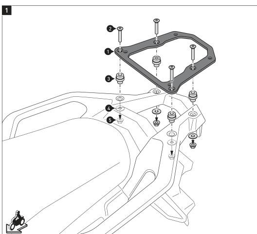
Verschrauben Sie das Anbaublech (1) am Fahrzeug. Ziehen Sie die Schrauben wie vorgegeben an.
