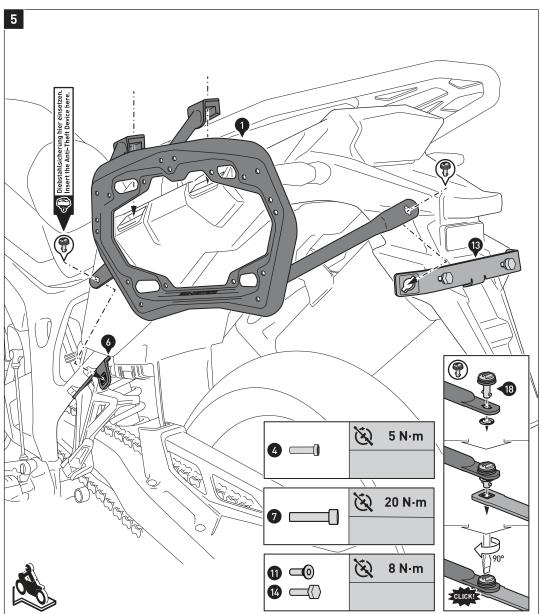
Verbinden Sie die Seitenträger (1) mit den Schnellverschlüssen (18) am Querverbinder (13) und den Befestigungslaschen (6) und (9/10). Sichern Sie die Schnellverschlüsse mit den Sicherungsscheiben.
