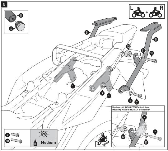
HINWEIS: Wenn der Gepäckträger mit dem SW-MOTECH Seitenträger montiert wird, entfallen die Schrauben (10). Montieren Sie stattdessen die markierten (\*) Teile des Gepäckträgers, wie in der Detailzeichnung gezeigt.
