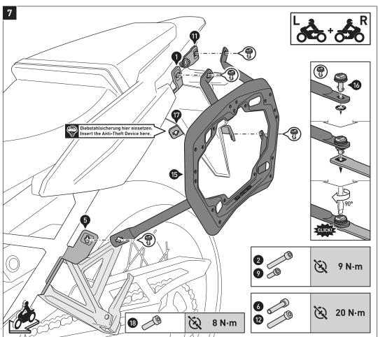
Verbinden Sie die Kofferträger (15) mit den Schnellverschlüssen (16) an den Befestigungslaschen (5)/(6) und (11) und den Querverbindern (1) und (17). Sichern Sie die Schnellverschlüsse mit den Sicherungsschei-
