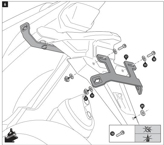
Verschrauben Sie den Querverbinder (17) am Fahrzeug, wie in der Zeichnung gezeigt, Ziehen Sie die Schrauben noch nicht an
