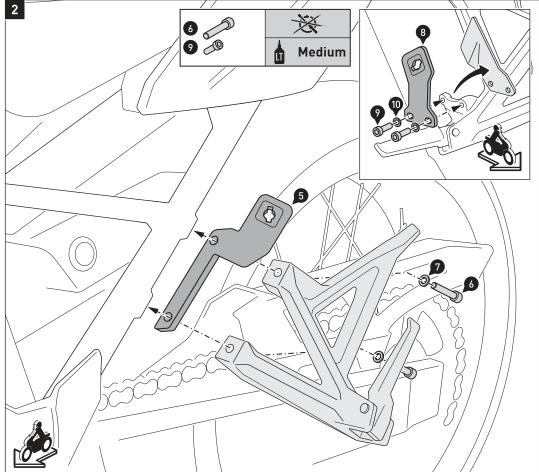
Montieren Sie die Befestigungs-lasche (5) auf der linken Fahrzeugs-eite mit der Fußraste am Rahmen, wie in der Zeichnung gezeigt.
