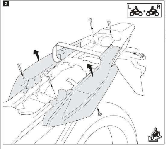
Entfernen Sie beidseitig die gezeigten Schrauben und anschließend die hinteren Seitenverkleidungen vom Fahrzeug. Achten Sie dabei auf die Kunststoffhaken der Seitenverkleidungen.
