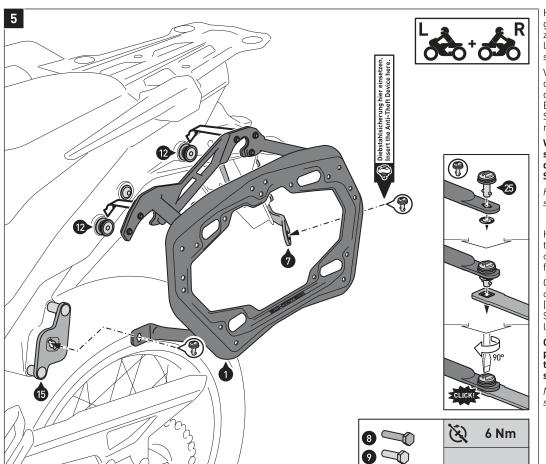
Hängen Sie beidseitig die Seitenträ-ger (1) und (2) an die Führungsbol-zen; drücken Sie die Seitenträger leicht nach unten, bis diese fest
