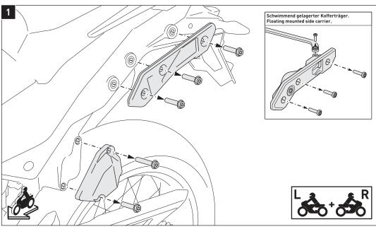
HINWEIS: Die Montage ist linksseitig dargestellt. Wiederholen Sie die Montage mit den entsprechenden Teilen auf der rechten Fahrzeugseite analog zur linken Fahrzeugseite.
