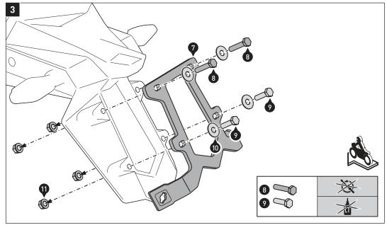
Verschrauben Sie den Querverbinder (7) am Kennzeichenhalter, wie in der Zeichnung gezeigt. Ziehen Sie die Schrauben noch nicht an.
