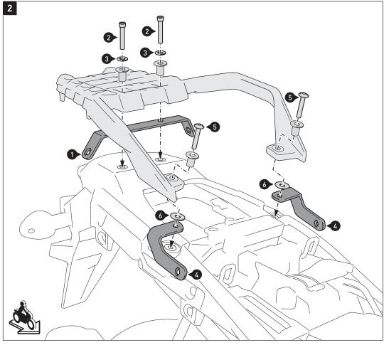
Verschrauben Sie den Querverbinder (1) und die Befestigungslaschen (4) mit den original Bundbuchsen und Gepäckträger am Fahrzeug, wie in der Zeichnung gezeigt.
