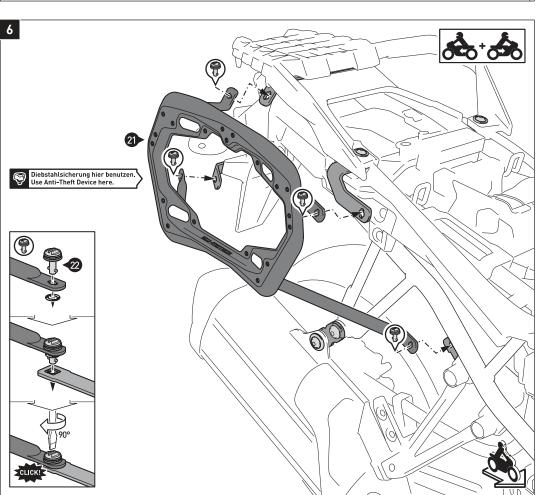
Verbinden Sie die Kofferträger (21) beidseitig mit den Schnellverschlüssen (22) an den Befestigungslaschen und Querverbindern. Sichern Sie die Schnellverschlüsse mit den Sicherungsscheiben.
