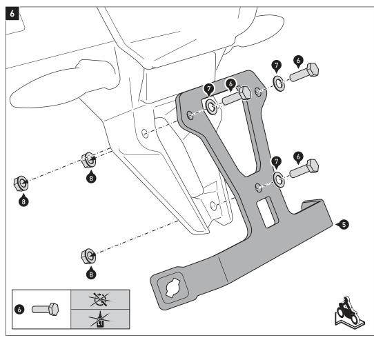
Verschrauben Sie den Querverbinder (5) am Kennzeichenhalter, wie in der Zeichnung gezeigt. Ziehen Sie die Schrauben noch nicht
