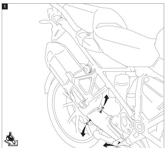
Lösen Sie die markierten Schrauben der Auspuffverkleidung und entfernen Sie diese vom Fahrzeug.
