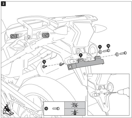
Richten Sie den Querverbinder (9) parallel zur oberen Kante des Kotflügels aus.
