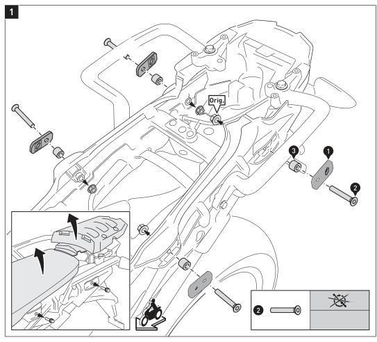
Entfernen Sie die Sitzbank und die obere Heckverkleidung vom Fahrzeug, wie in der Detailzeichnung gezeigt.
